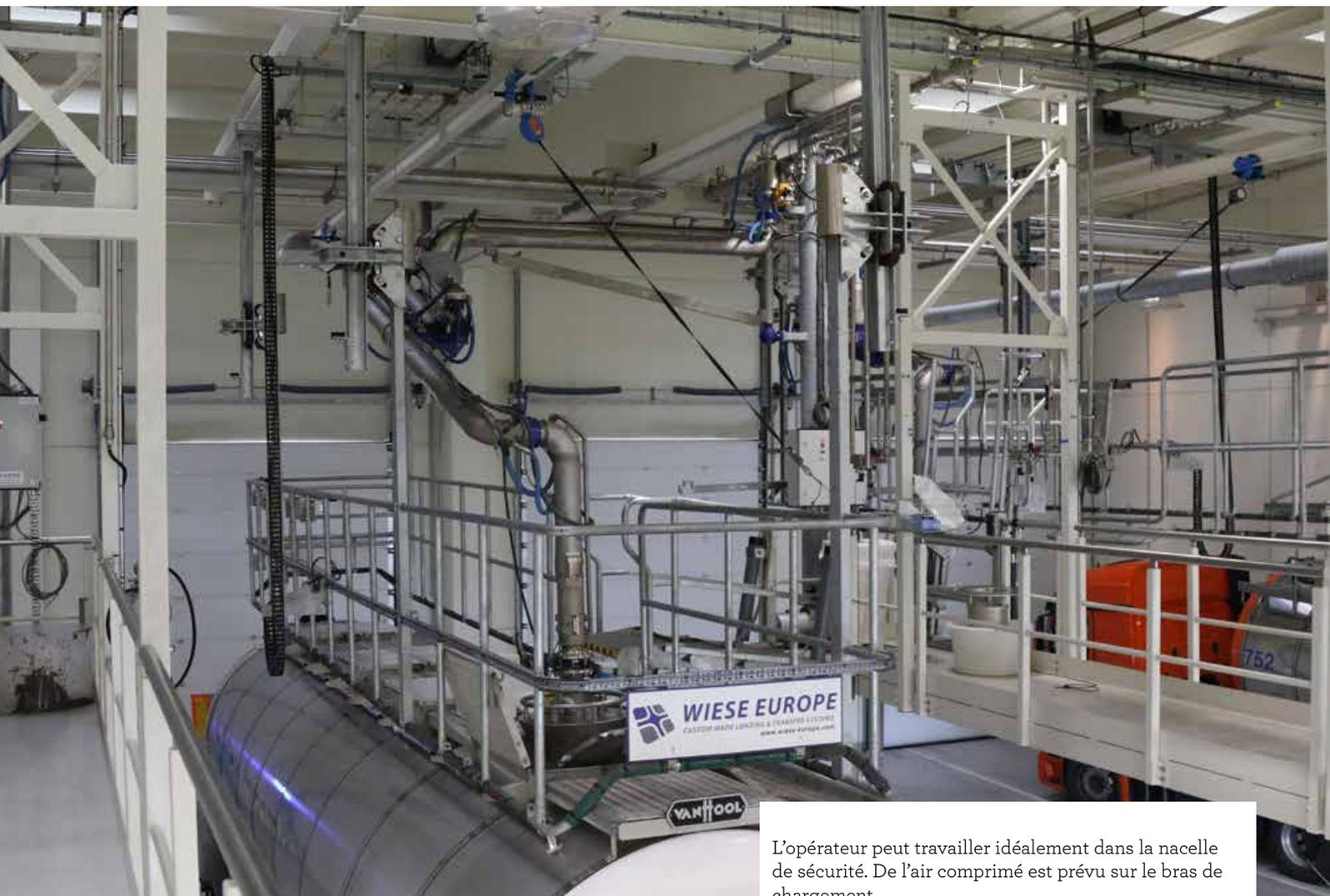
L'opérateur peut travailler idéalement dans la nacelle de sécurité. De l'air comprimé est prévu sur le bras de chargement.
